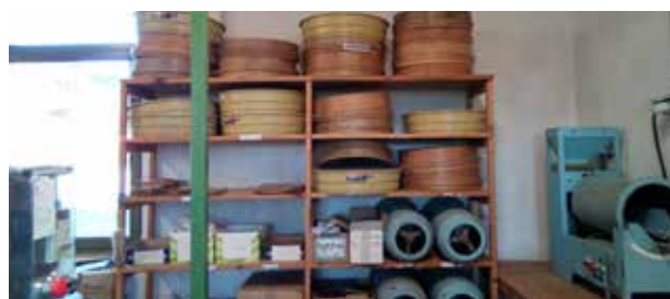
Tamis et trieur cylindrique (à droite)
