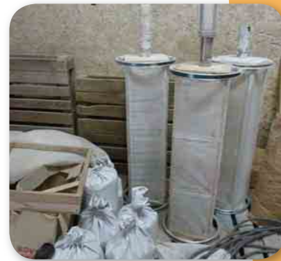
Tamis expérimentaux réalisés par l'atelier PAIS.
