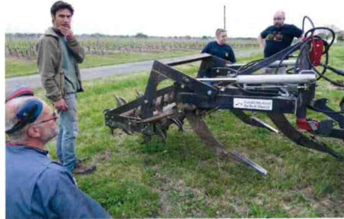
■ Photo 2: Démonstration et test de l'outil de décompaction superficielle des sols: « Réhabilitator ».
